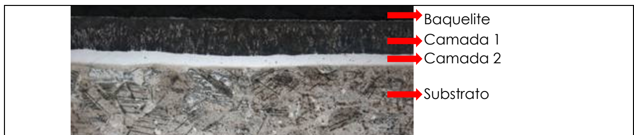
Figura 1 – Camadas nitretadas formadas na superfície dos aços inoxidáveis austeníticos
