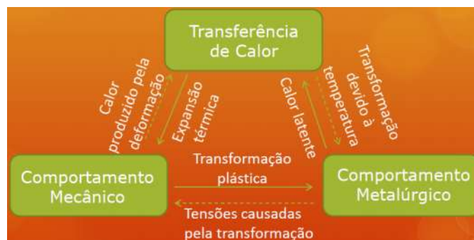
Figura – principais interações durante a têmpera de uma liga ferrosa
