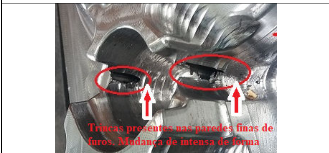
Zonas de transição com paredes finas / furos – macrotrincas presentes
