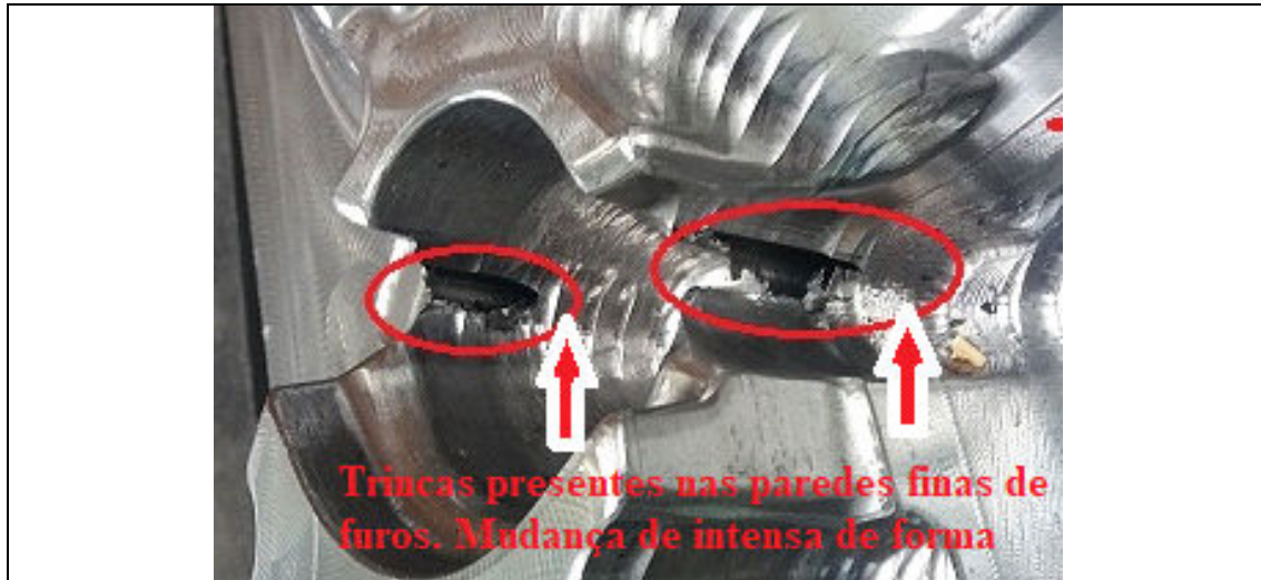
Zonas de transição com paredes finas / furos – macrotrincas presentes
