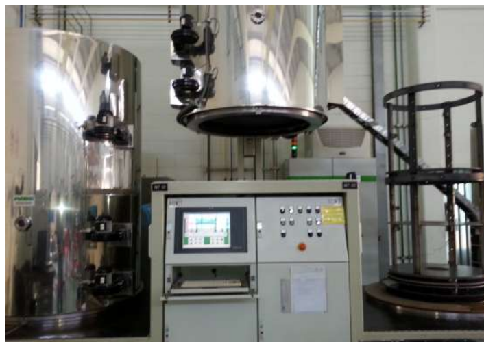
Figura 3 – Reator de nitretação a plasma da Isoflama ®
