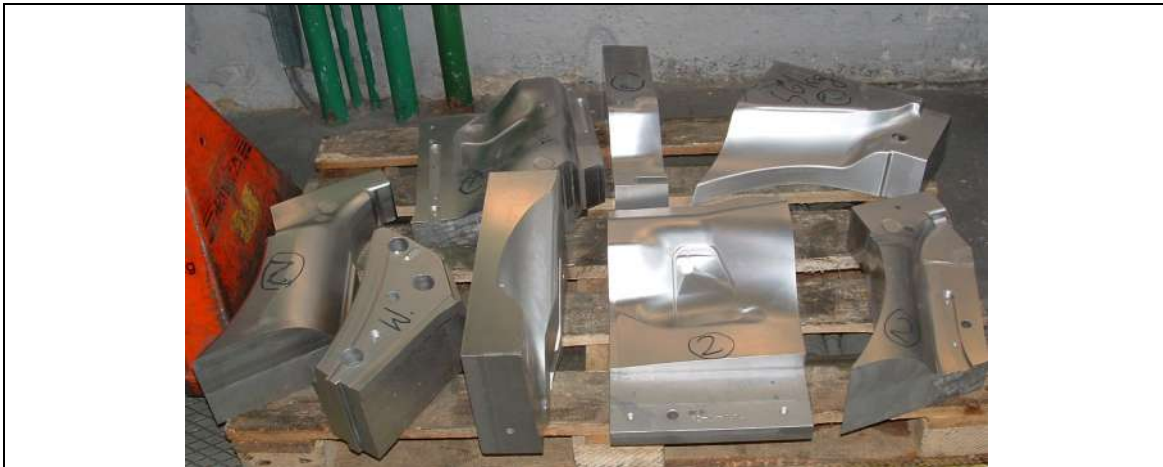
Figura 8 – Matriz para conformação a frio segmentada
