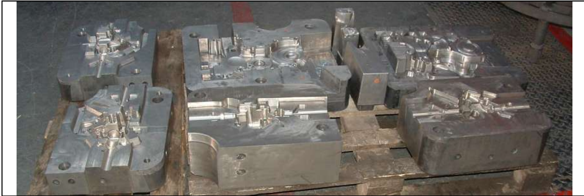
Figura 7 – Moldes em aço para o setor de injeção de alumínio
