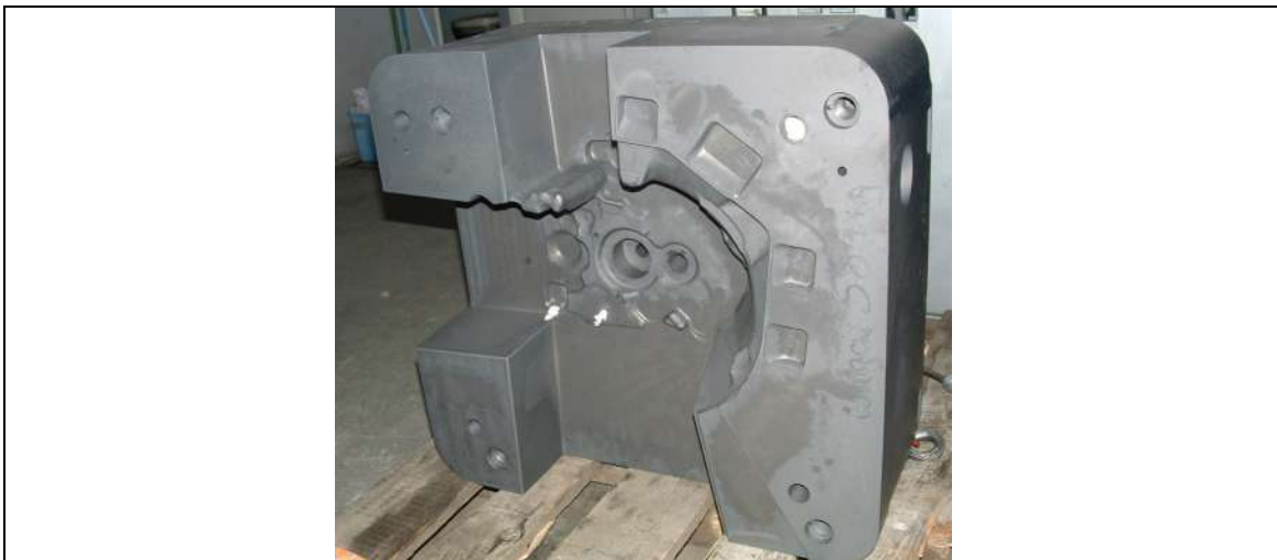
Figura 4 – Molde em aço para injeção de alumínio
