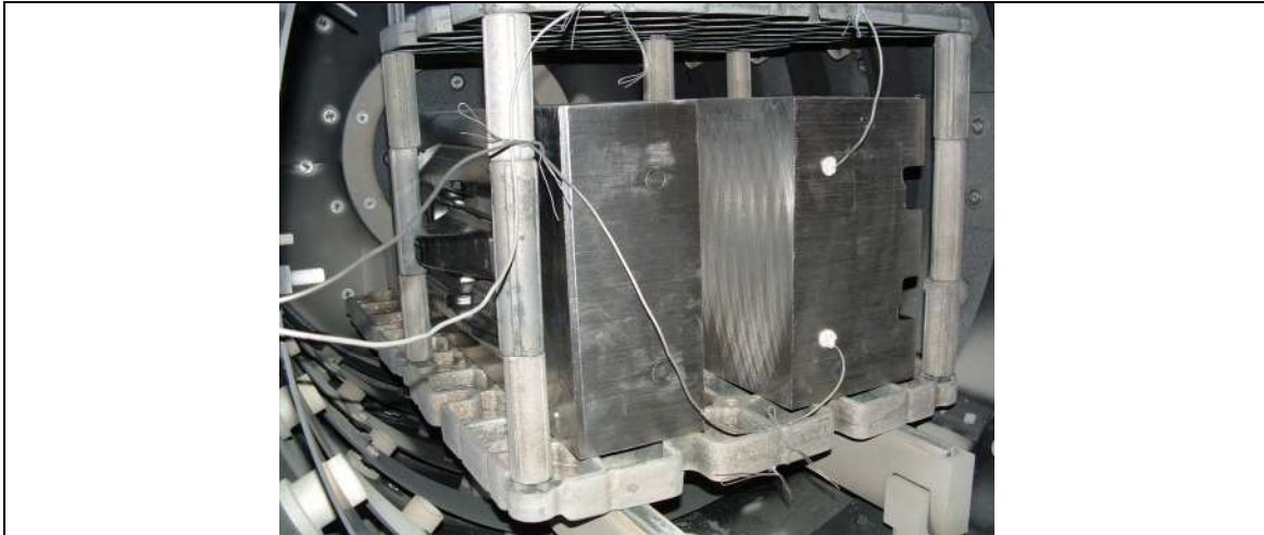
Figura 5 – Matrizes montadas na grelha no interior do forno de têmpera
