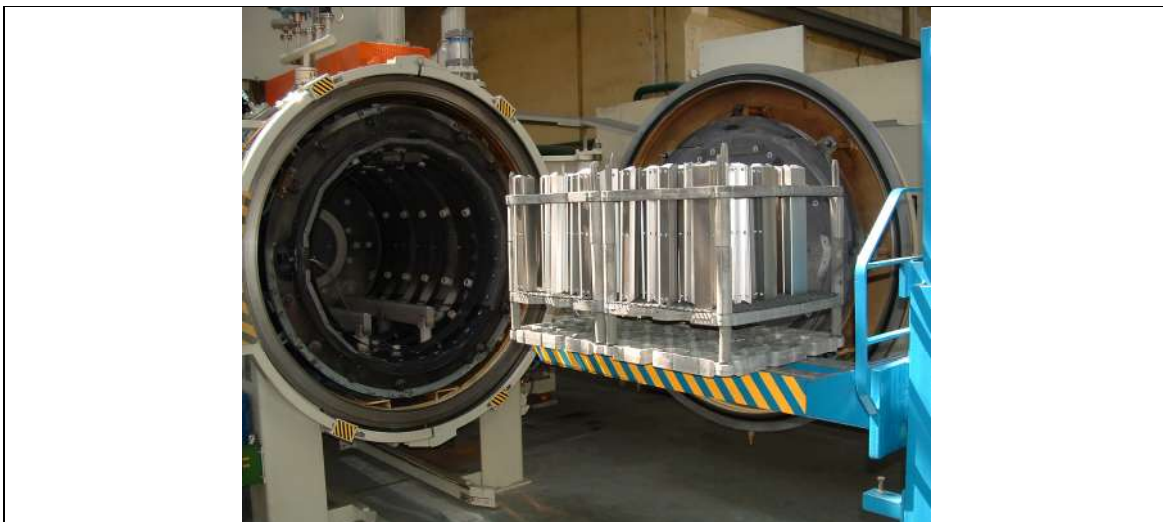
Figura 6 – Carga de aço inoxidável sendo introduzida no forno de têmpera
