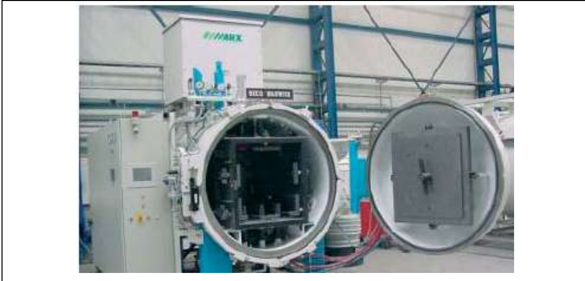
Figura 1 – Forno a vácuo com câmara de seção retangular. Foto SW
