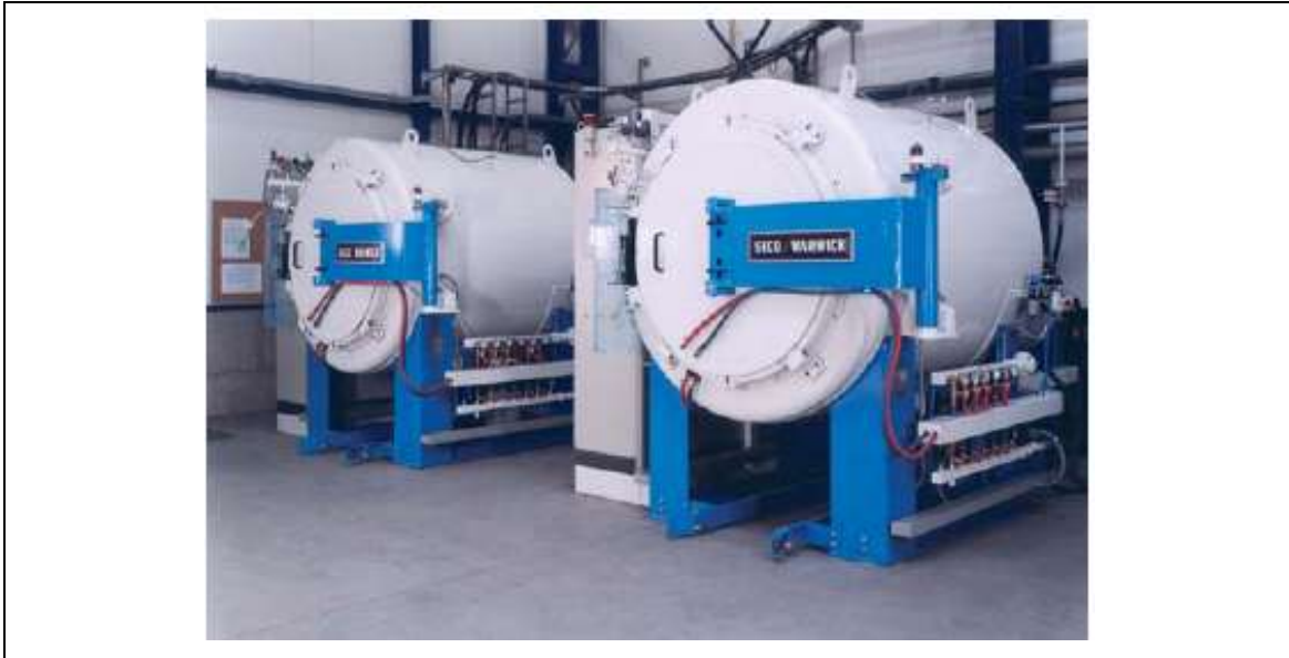
Figura 8 – Fornos tipo VTR para tratamento de cargas acima de 600 kg
