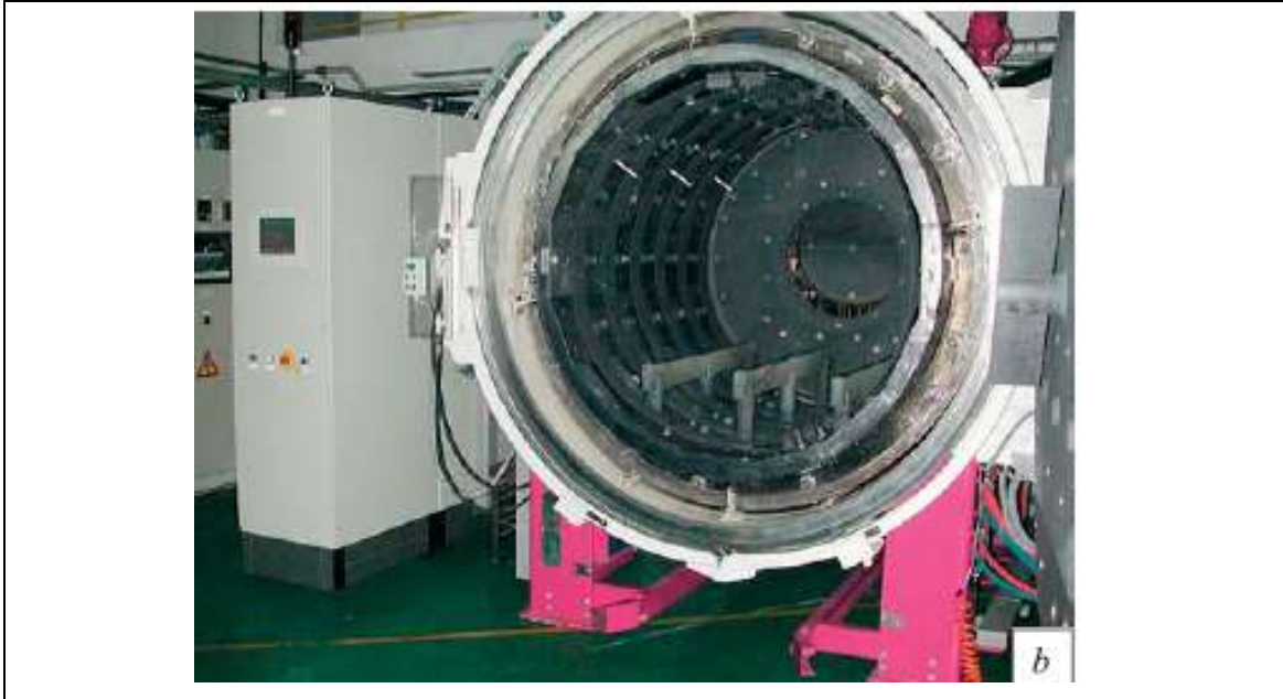
Figura 3 – Forno a vácuo (com porta aberta) de câmara cilíndrica.
