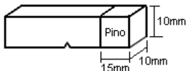
Figura 3. Pino, utilizado no teste de abrasão, extraído do corpo de prova do teste de impacto.
