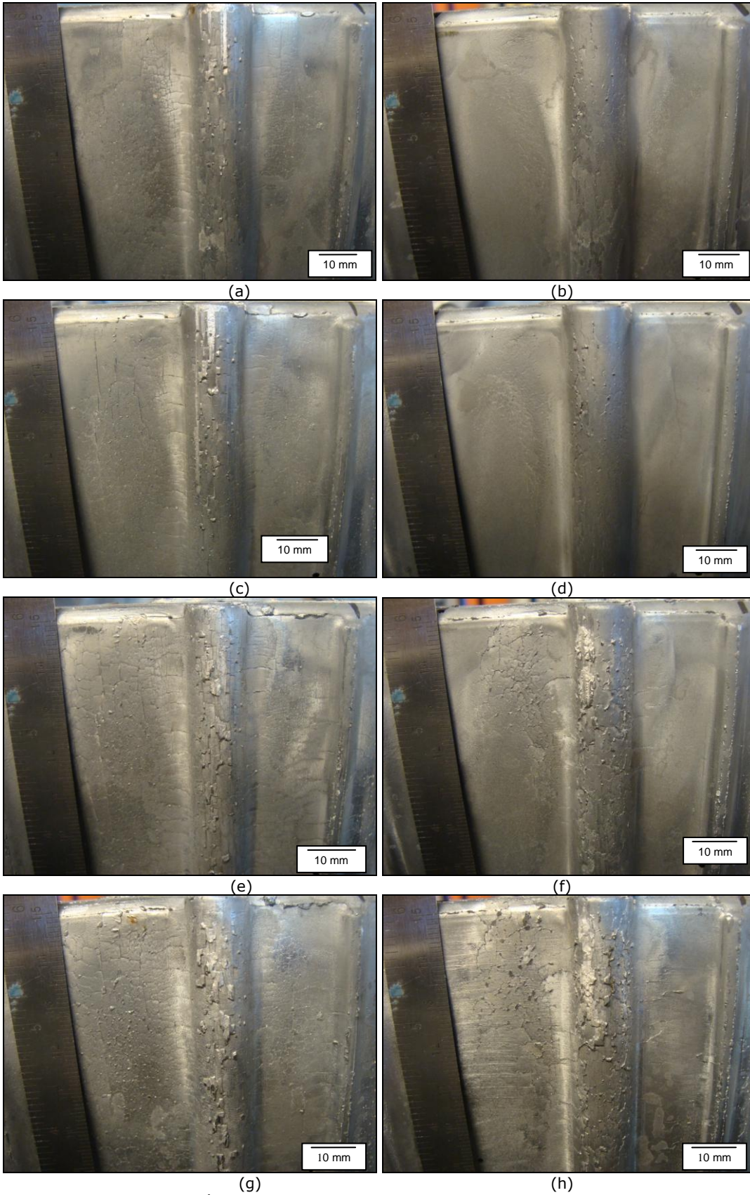
Fig. 3. Grietas de fatiga térmica en la zona A del componente inyectado: (a) AISI H11 a 10.000 ciclos, (b) HTCS ® a 10.000 ciclos, (c) AISI H11 a 25.000 ciclos, (d) HTCS ® a 25.000 ciclos, (e) AISI H11 a 50.000 ciclos, (f) HTCS ® a 50.000 ciclos, (g) AISI H11 a 75.000 ciclos y (h) HTCS ® a 75.000 ciclos.
