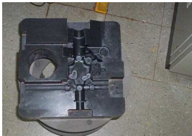
FIGURA 3 - Molde para injeção de alumínio, nitretado e oxidado (magnetita). Fonte: UNICAMP (2011).
