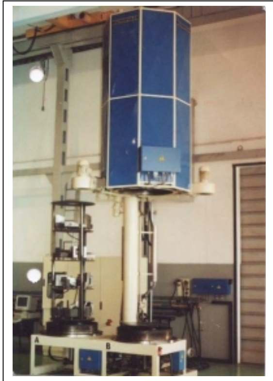
Figura 2- Equipamento de nitretação iônica, 750x2000mm
