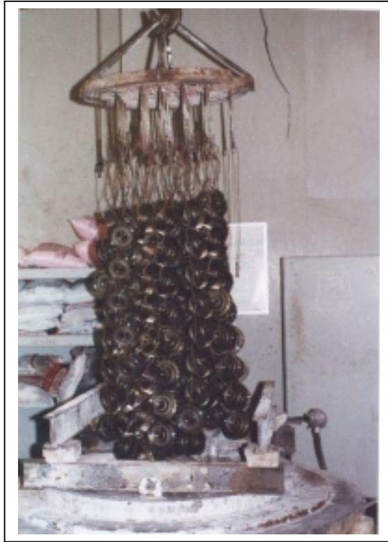
Figura 1- Equipamento de nitretação em banho de sal, 600x1600mm
