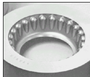
Fig 14. Este inserto em Stavax ESR foi acabado através de EDM "polimento".
