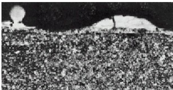
Fig 1 Uma superfície desbastada via eletro erosão, seção cortada que mostra as crateras e os cavacos. Material ORVAR 2M microgranulado.
